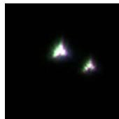
Photo de l'étoile double Castor, présentant un aspect triangulaire à cause des déformations du miroir principal sur son barillet. Le 1<sup>er</sup> anneau d'Airy est visible sous la forme de 3 points à 120° autour de la tache centrale. Les défauts sont ici renforcés par un traitement en ondelettes.
